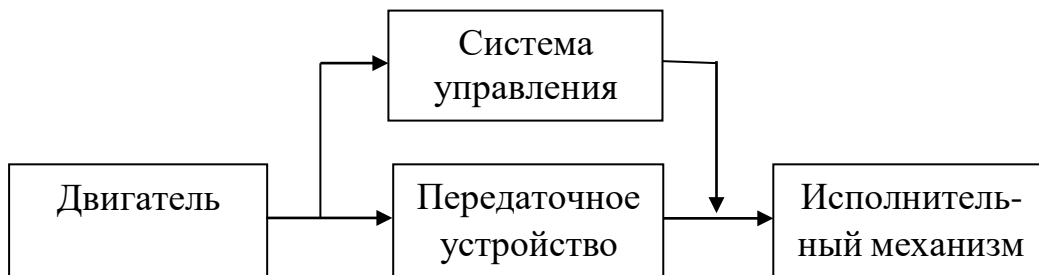
Рис1. Принципиальная схема машины
